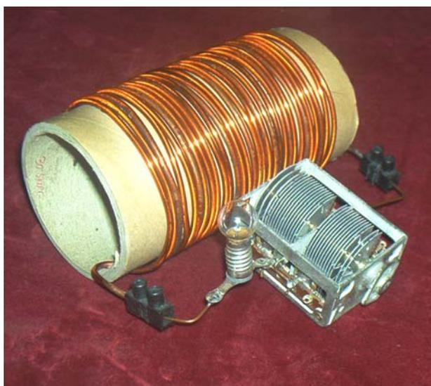
Fig. 14.5 - Circuito risonante ricevitore con la lampadina da 6 V -
